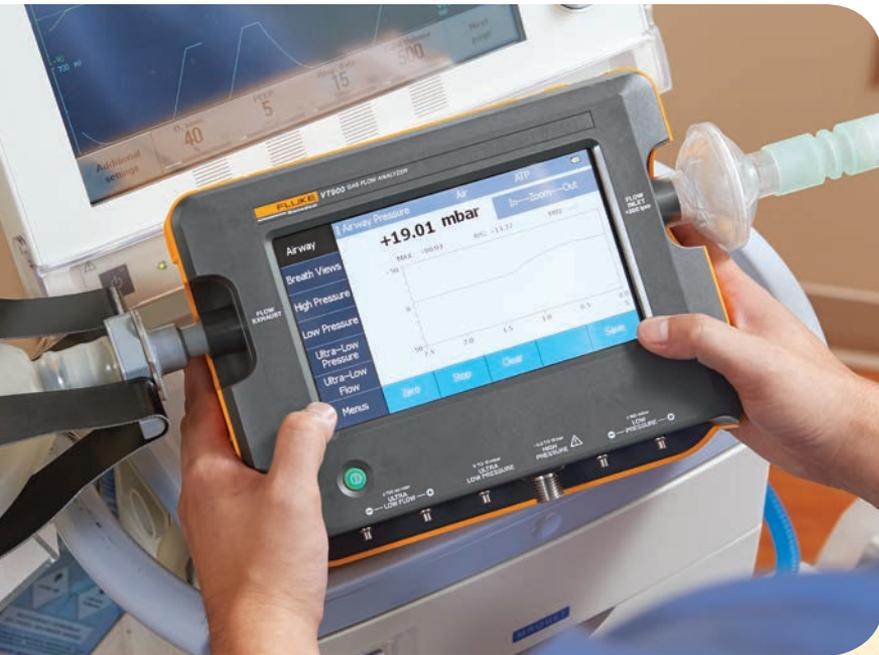
Fluke Biomedical VT900 は、ベンチレーター、空気吸入器、酸素メーターなど、あらゆる種類の医療用ガス流量機器を正確かつ高い信頼性でテストするよう設計されています。特に、麻酔機器やフローメーターなど、超低流量および超低压測定において高い精度が要求される機器に適しています。
