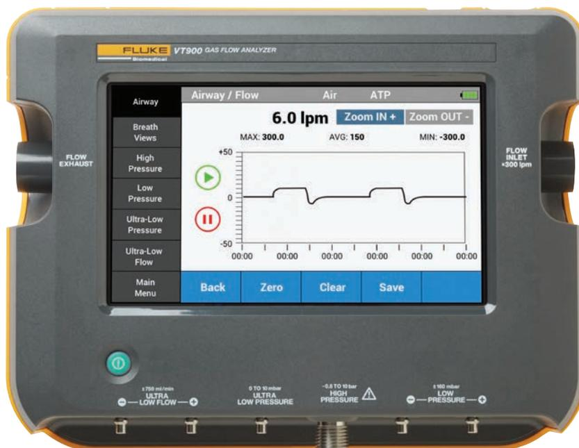
Canal de flujo de aire de ±300 lpm con mediciones incorporadas de oxígeno, humedad y temperatura
