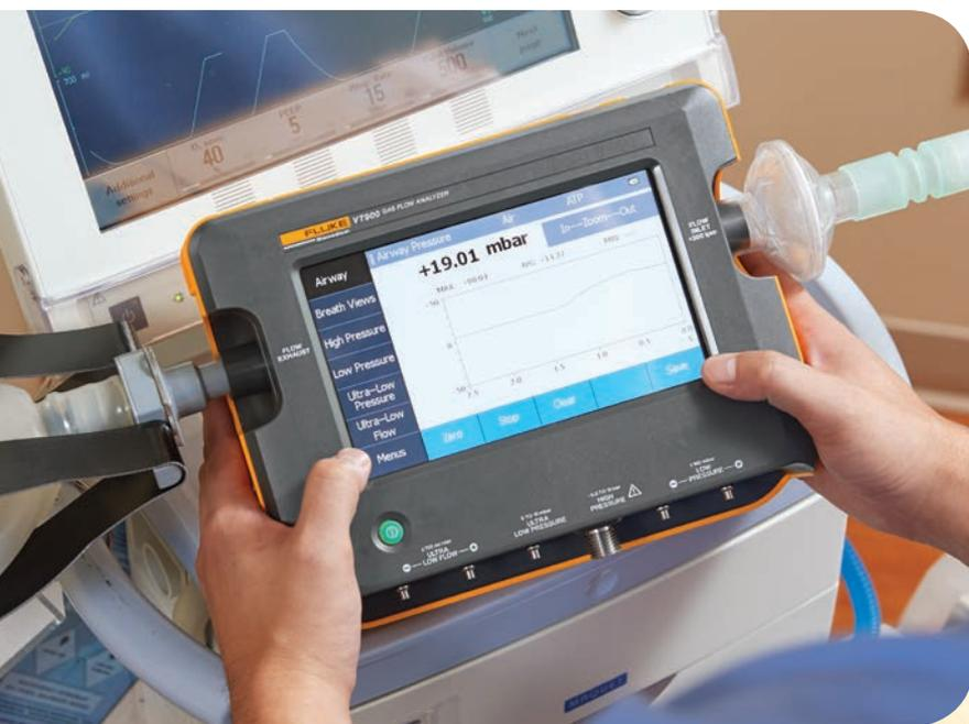
Газоанализатор VT900 от компании Fluke Biomedical предназначен для точного и надежного анализа всех типов газового медицинского оборудования — аппаратов ИВЛ, инсуффляторов, оксиметров, особенно для которых требуется высокая точность измерений сверхслабого потока и сверхнизкого давления, например наркозных аппаратов и расходомеров.
