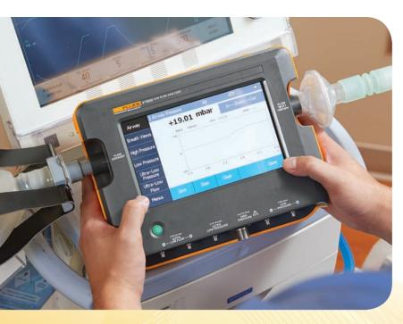
Fluke Biomedical VT900은 인공호흡기, 취입기 및 산소측정기를 포함한 모든 유형의 의료 기체 유량 장비를 정확하고 신뢰성 높게 테스트하도록 설계되었습니다. 특히 높은 정확도를 요구하는 마취 장비나 유량계 등의 초저 유량 및 초저 압력 측정에 사용됩니다.
