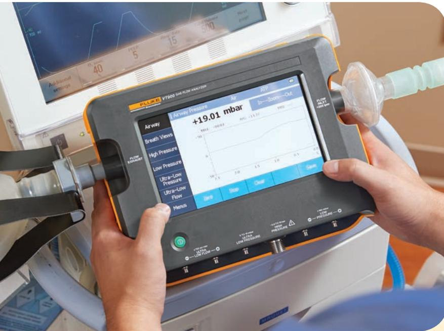
**Il flussimetro e analizzatore per gas Fluke Biomedical VT900 è progettato per verificare in modo preciso e affidabile tutti i tipi di apparecchiature di misurazione della portata dei gas medicali, come ventilatori, insufflatori, misuratori di ossigeno, in particolare quelle che richiedono un'elevata precisione nelle portate e nelle pressioni ultra basse, quali macchine per anestesia e flussimetri.**
