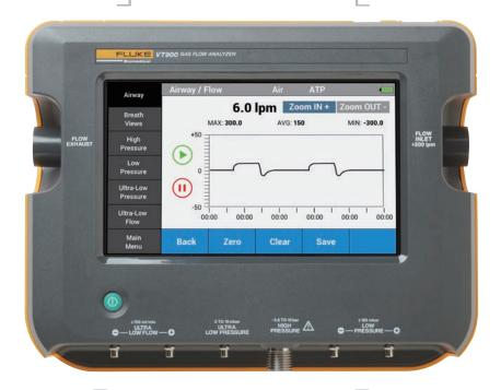
Luftstromkanal für den gesamten Bereich ± 300 lpm mit integrierten Sauerstoffgehalt-, Luftfeuchtigkeit- und Temperaturmessungen
