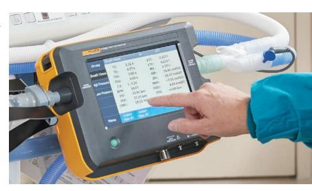
온보드 메모리와 USB를 통해 간편하게 데이터를 옮기고 CMMS에 테스트 파일을 업로드. 실시간 그래프 및 테스트 데이터를 보여주는 7인치(17.8cm) 컬러 터치 스크린. 사용자, 테스트 유형 또는 모델별로 맞춤형 테스트 프로필 및 데이터 로깅을 사용할 수 있습니다.
