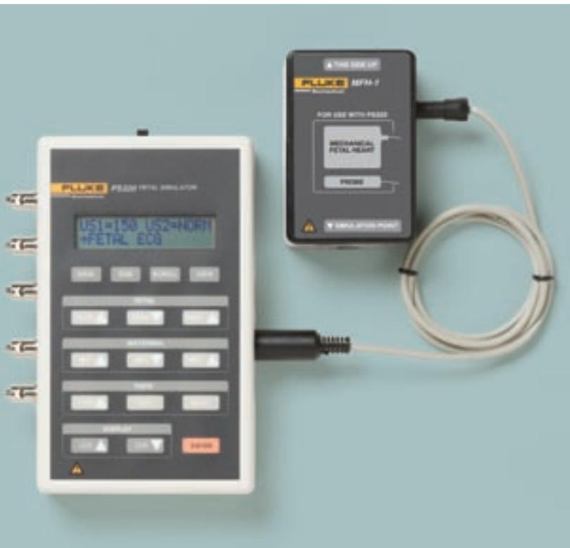
PS320 は、胎児監視装置のテストやトラブルシューティング、臨床スタッフへのトレーニングを行う目的で、胎児と妊婦の心電波形および子宮の活動をシミュレートします。
