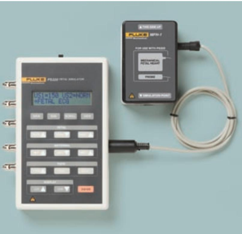
PS320 胎儿模拟器可通过模拟胎儿和母体的心电图 (ECG) 波形以及子宫活动, 以对胎儿监护仪进行测试和故障排除, 并训练临床医护人员。
