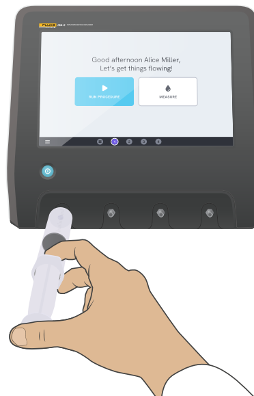
Figure 24 : Drainage d'un canal
