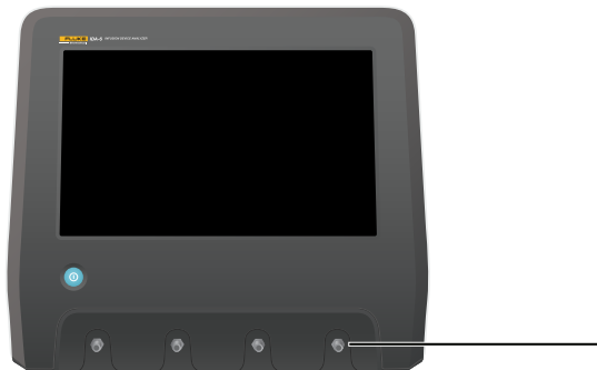
Figure 8 : Hauteur de référence pour la pression
