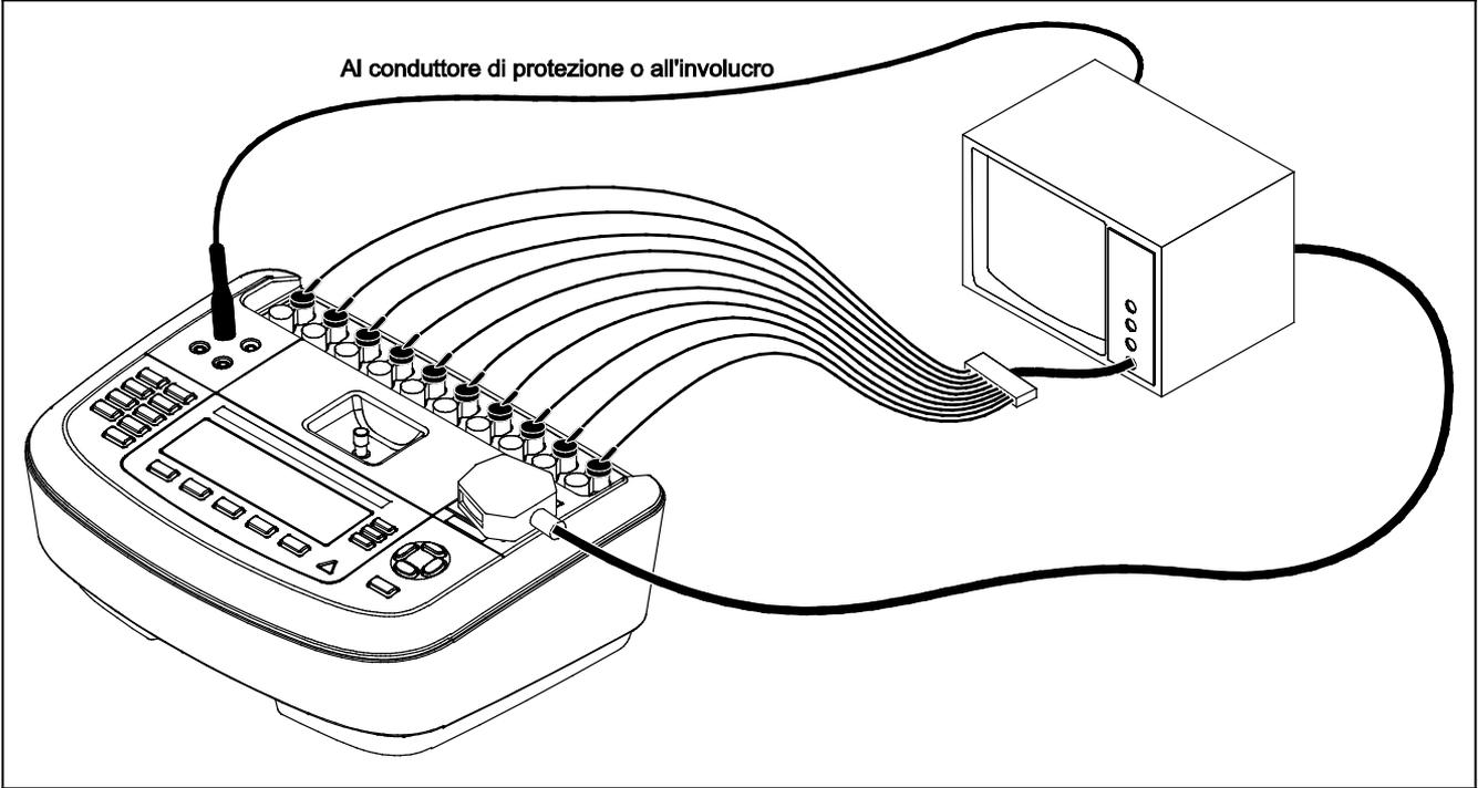
**Figura 4. Collegamento di un dispositivo all'analizzatore**
