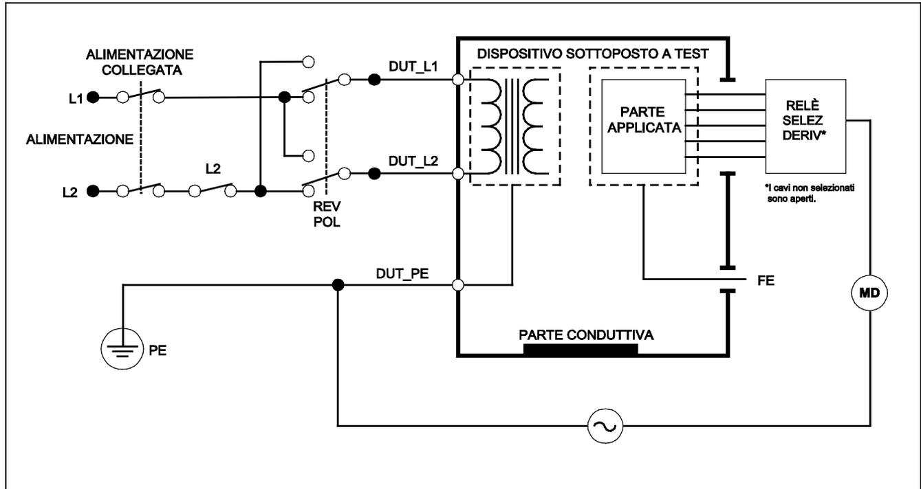
Figura 28. Schema del test diretto della corrente di dispersione delle parti applicate
