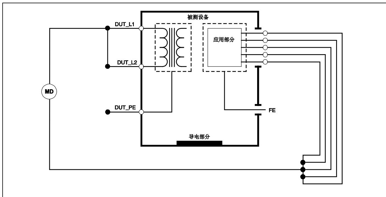
图 15. 电源对应用部分绝缘测试示意图
