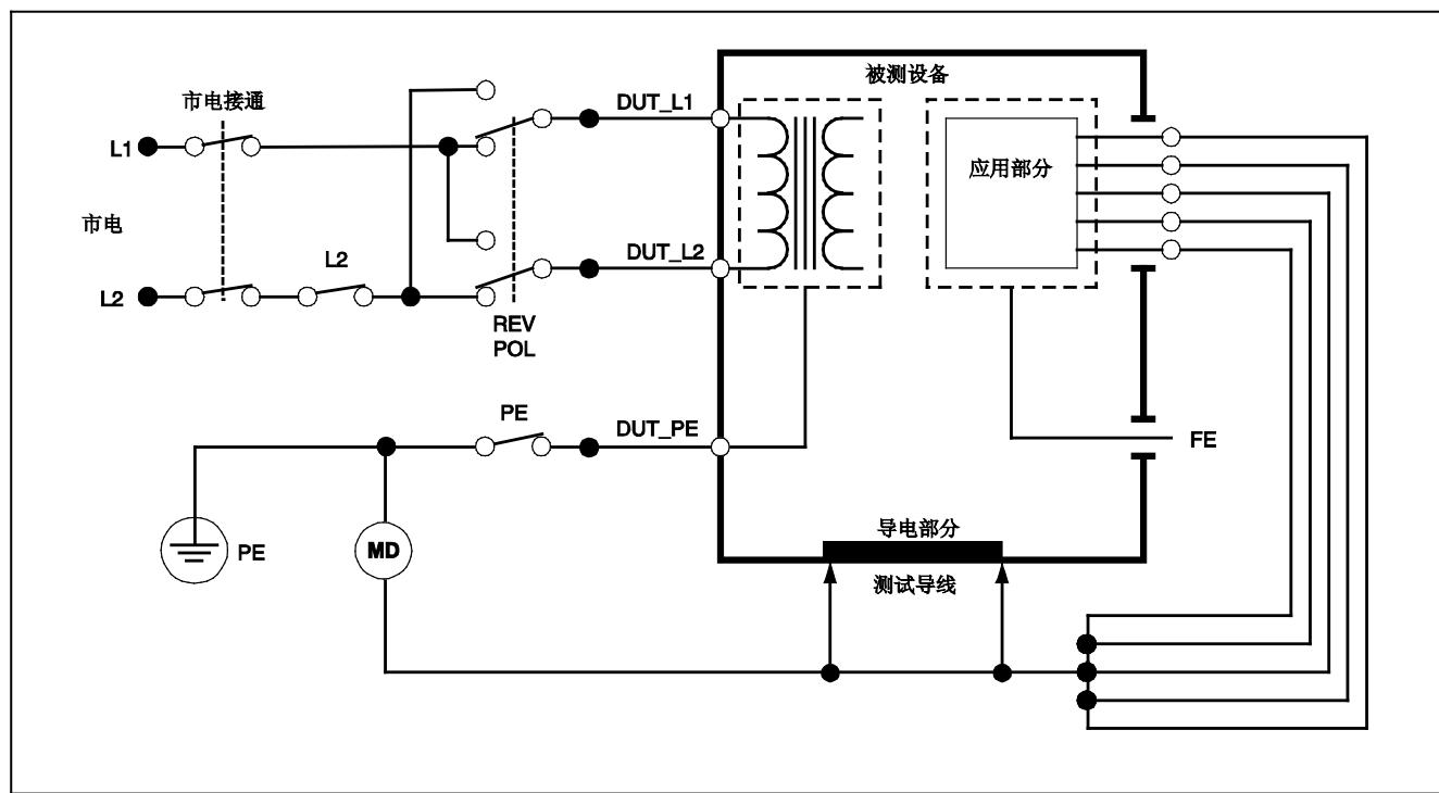
图 27. 直接设备漏电流测试示意图
