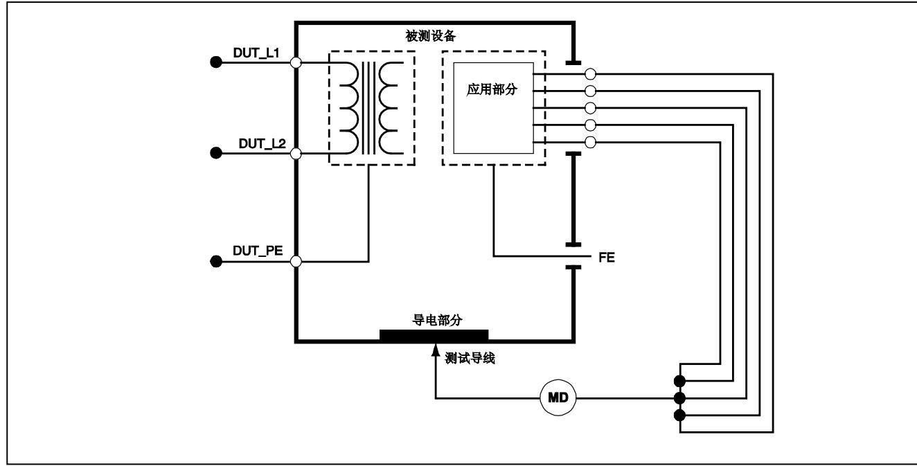
图 17. 应用部分对非接地导电点示意图
