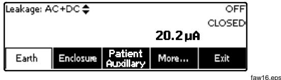
图 18. 漏电流测试主菜单
