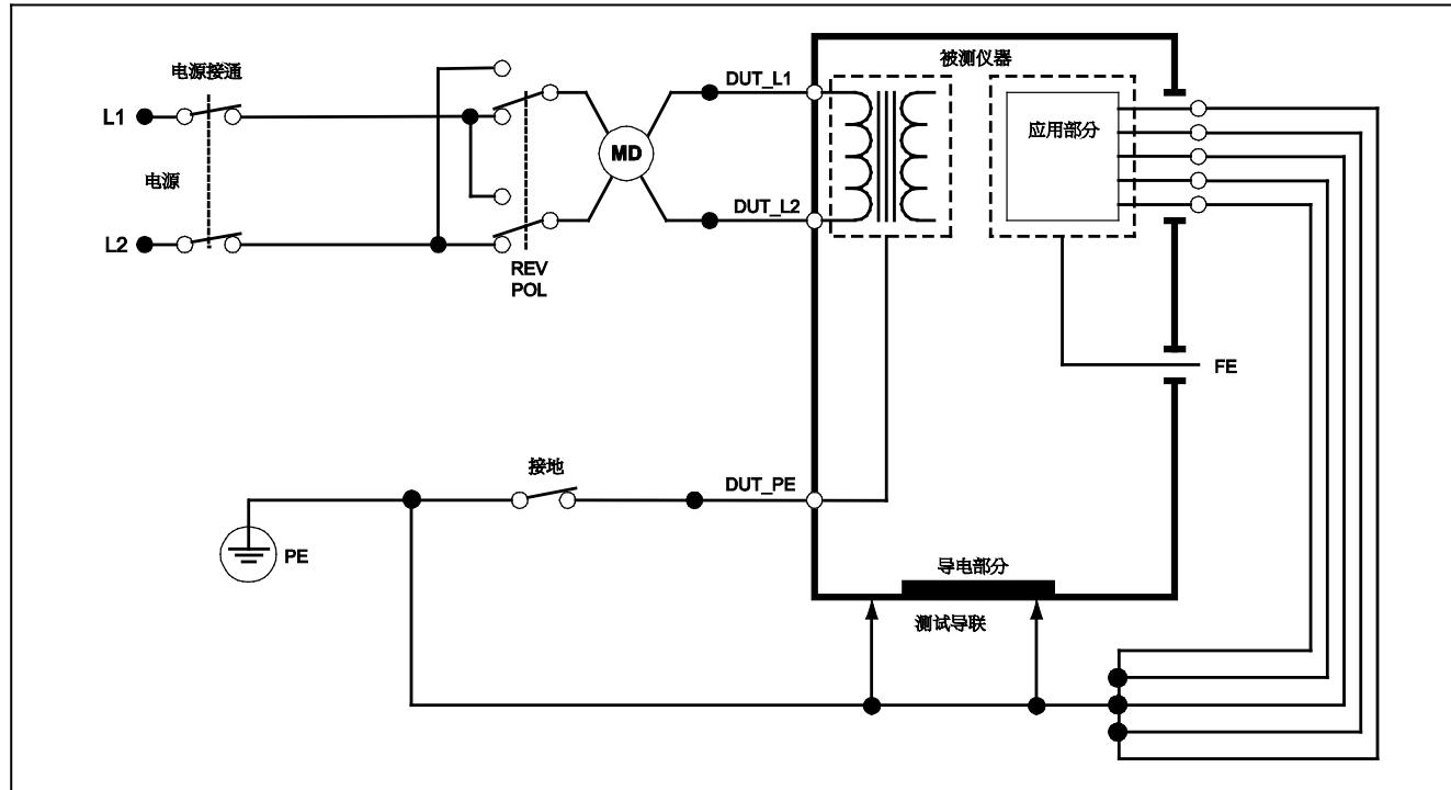
图 29. 差值漏电流测试示意图
