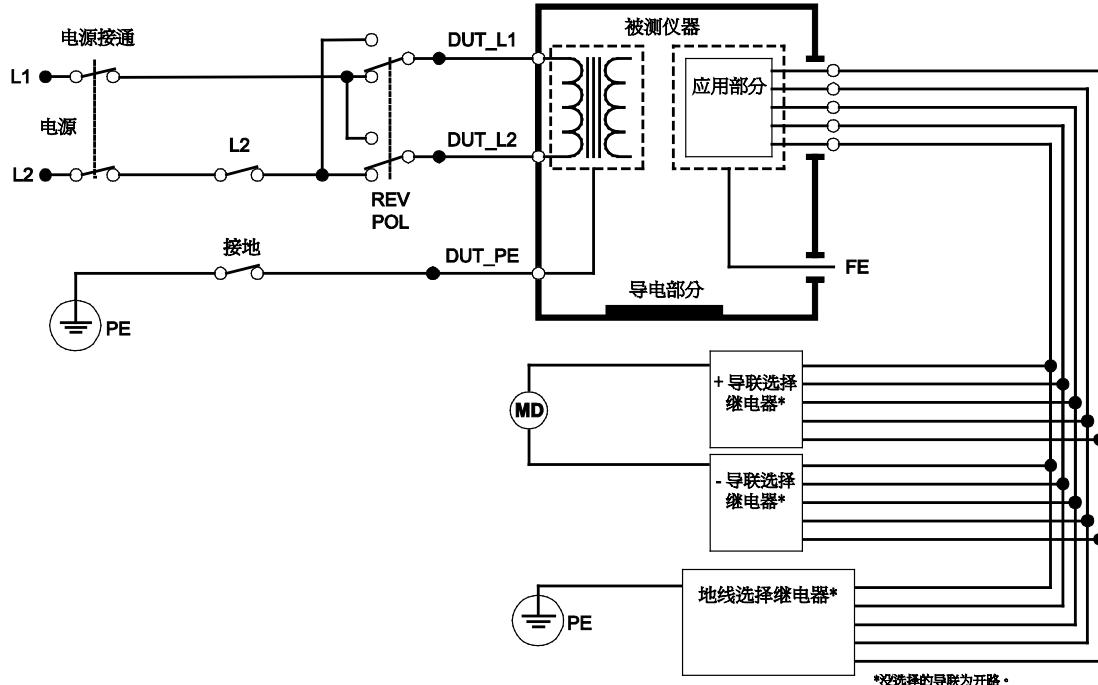
图 23.患者辅助漏电流测试示意图
