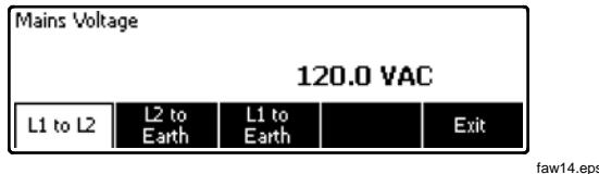
图 9. 电源电压测试菜单
