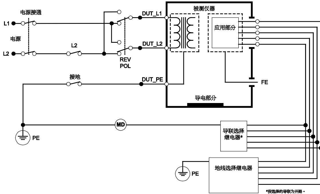
图 21.患者漏电流测试示意图
