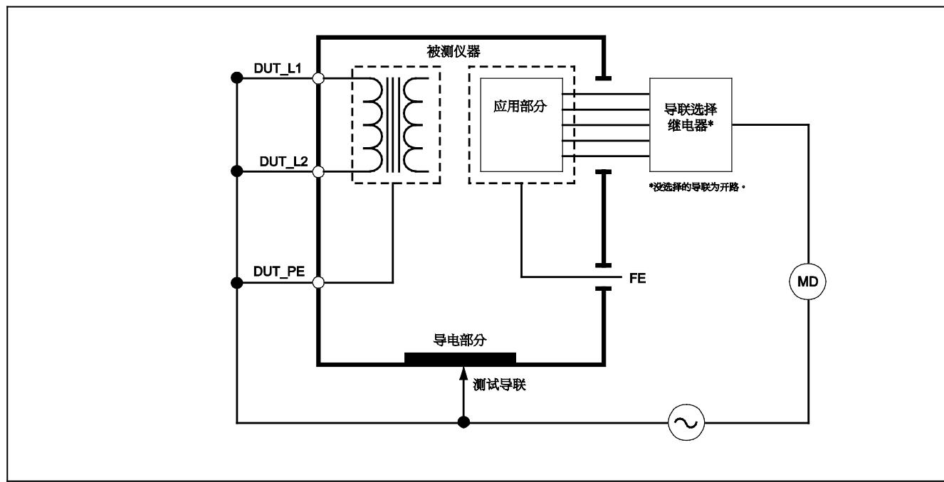
图 26. 应用部分等效漏电流测试示意图
