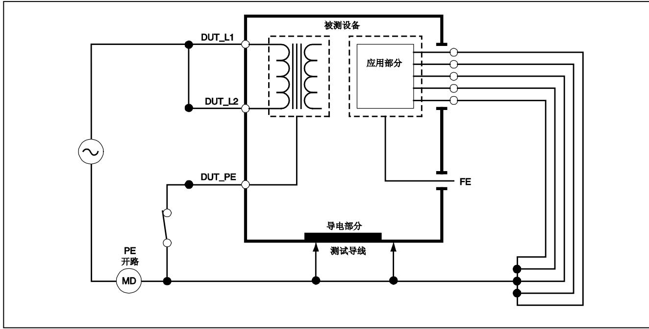
图 25. 等效设备漏电流测试示意图
