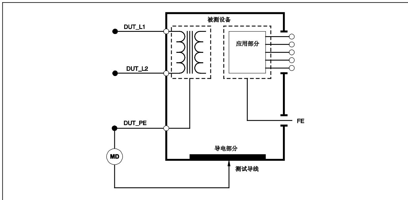
图 11. 保护接地电阻测量示意图
