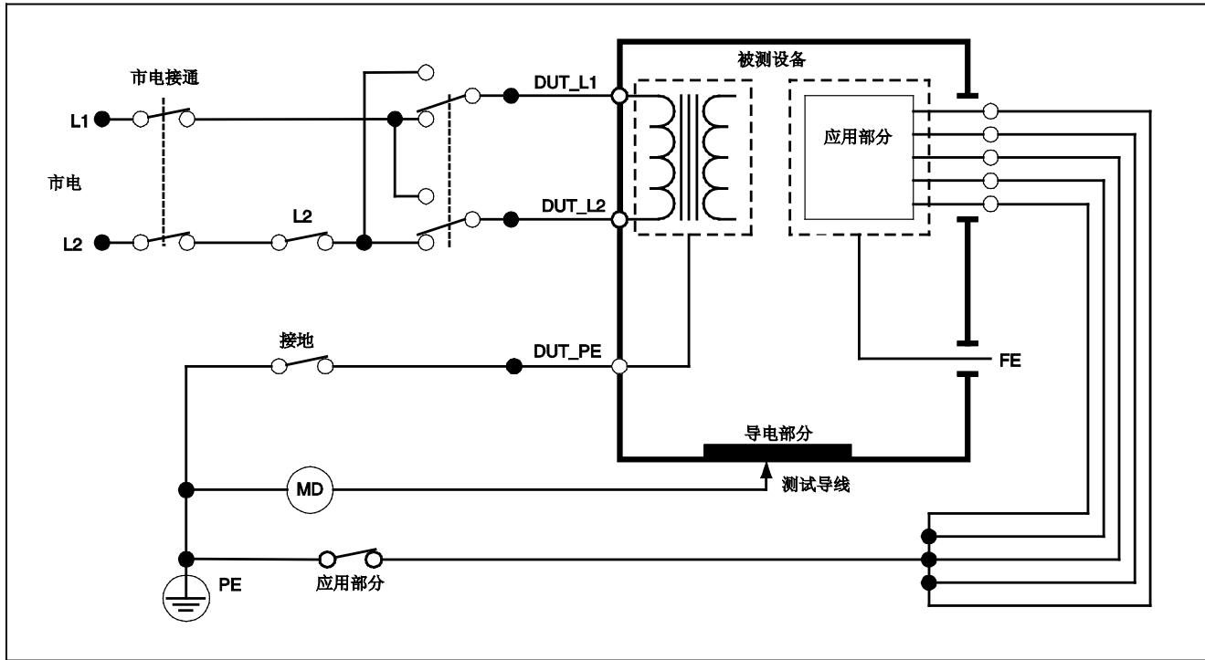
图 20. 外壳漏电流测试示意图
