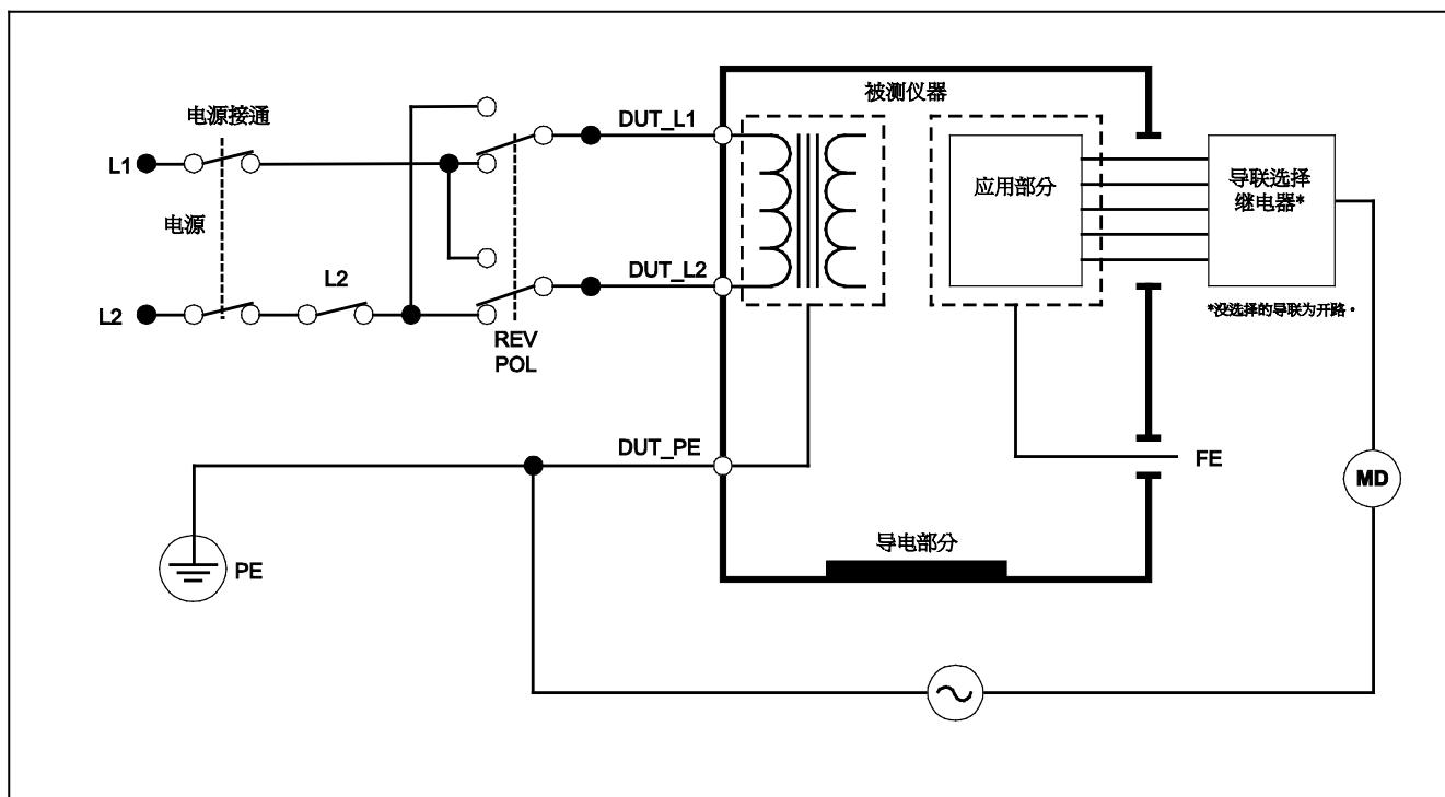
图 28. 应用部分直接漏电流测试示意图
