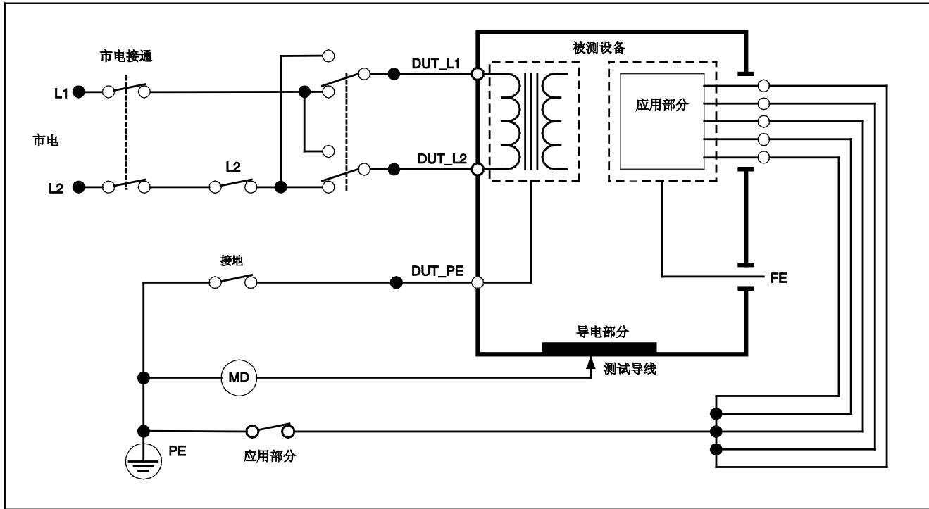
图 19. 接地漏电流测试示意图
