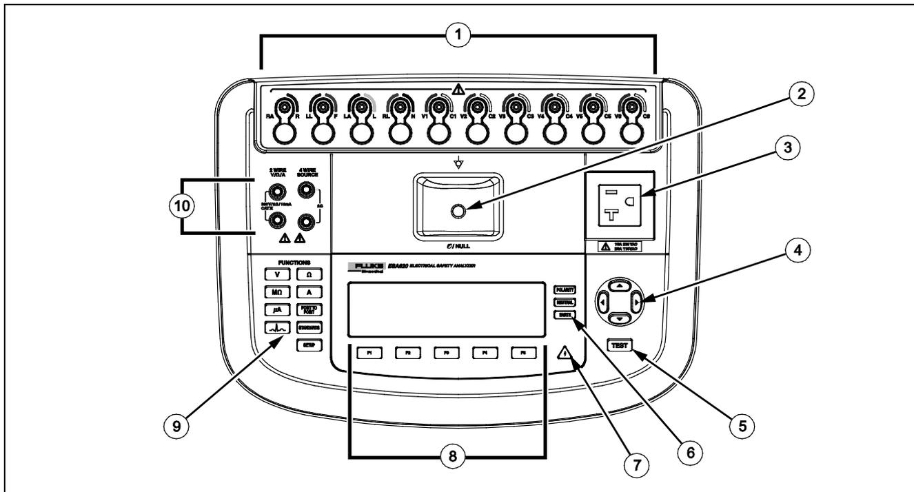
Figura 1. Controles e conexões do painel superior
