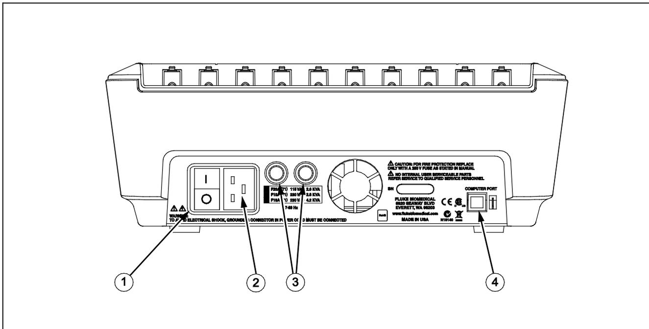
**Figura 2. Conexões do painel traseiro**
