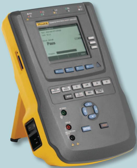
ESA615 电气安全分析仪是一款便携式分析仪，可供医疗技术管理专家（在现场和实验室对医疗设备进行电气安全测试）使用，可以快速简洁的进行自动测试。无论是简单测试还是综合性分析，ESA615 都能轻松完成。这款多功能分析仪不但可进行基本的电气安全测试，包括线路（电源）电压、接地（保护接地）电阻、绝缘电阻、设备漏电流以及导联（患者）漏电流测试等，还可以提供 ECG 模拟和点对点的电压、电流和电阻测试。ESA615 是一台集万用表、电气安全分析仪及 ECG 模拟器为一体的多功能测试仪器，内置多组可选的国际通用电气安全标准：ANSI/AAMI ES1，NFPA-99，IEC62353 (VDE751) IEC60601-1（第二版和第三版）以及 AS/NZS 3551。
