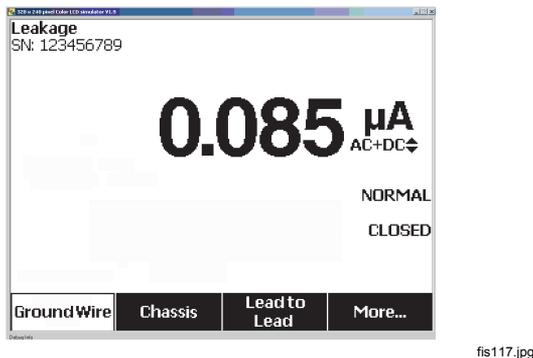
Figura 18. Menu principale del test della corrente di dispersione
