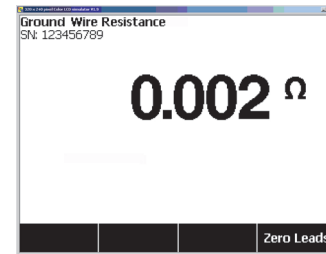
Figura 7. Medición de la resistencia de la línea a tierra del dispositivo bajo prueba
