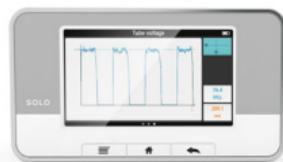
Pulse un parámetro para aumentar el tamaño de los dígitos. Deslice el dedo hacia la derecha para visualizar información del parámetro con especificaciones de mediciones, y hacia la izquierda para visualizar la forma de onda, si estuviera disponible para el parámetro actual.
