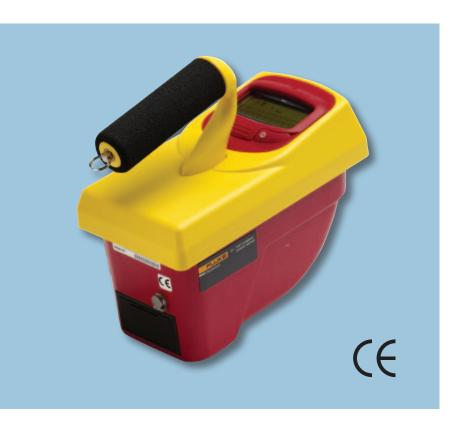
最新技術に基づく451P 電離箱サーベイメータは、苛酷な環境と通常環境の両方の条件に対応したハンドヘルド型バッテリ駆動機です。451P は加圧型電離箱で μR の分解能を持っています。451P は自動レンジ切替方式であり、各種の放射線源 (X 線とガンマ線) からの線量率と蓄積線量を測定します。電離箱検出器は漏出、散乱ビーム、およびピンホールからの放射線に対して高速な応答時間が可能です。加えて、低ノイズ チャンバ バイアス サプライによって迅速なバックグラウンド設定時間が可能になっています。
