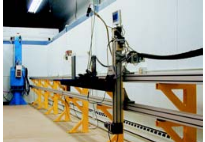
Tri-source range (20 Ci ^{137}\text{Cs} , 2000 Ci ^{137}\text{Cs} , 1300 Ci ^{60}\text{Co} )
