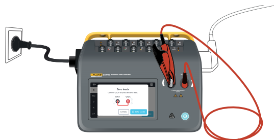
図9: テスト・リード1本とヌル端子アダプターを使用した、保護アース抵抗測定時のゼロ調整の設定。
