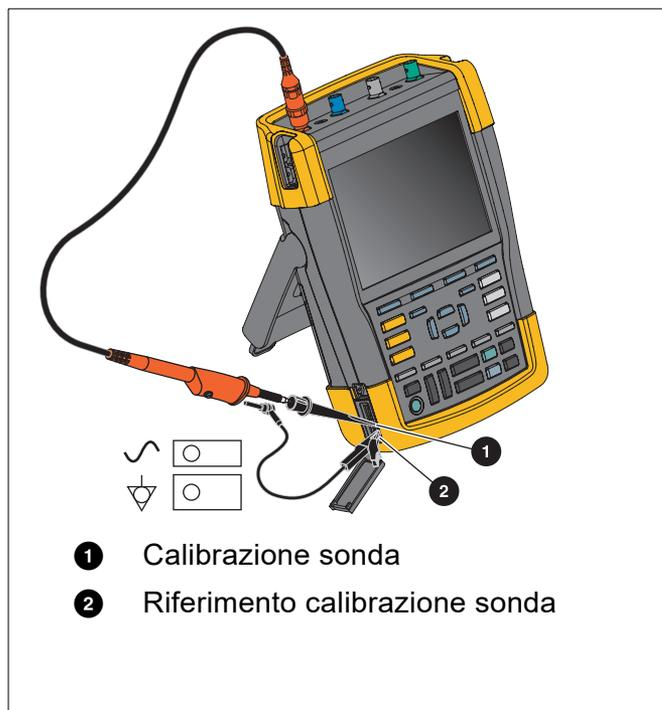
7. Regolare la vite di compensazione dell'alloggiamento della sonda finché sul display non viene visualizzata un'onda quadra pura.
