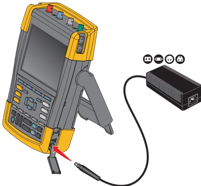
Alternativ können Sie den Akku auch durch einen vollständig geladenen Akku (Fluke Zubehör BP290 oder BP291) ersetzen und das externe Akku-Ladegerät EBC290 (Fluke Sonderzubehör) verwenden.
