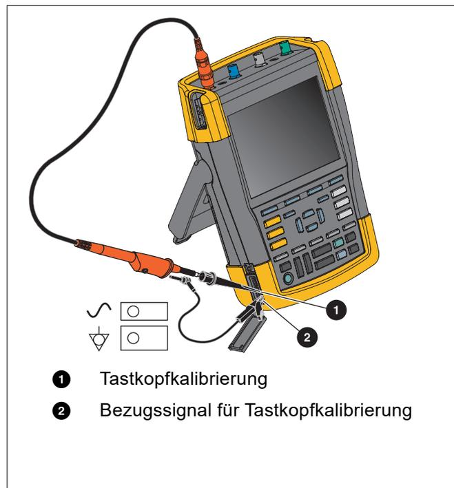
7. Stellen Sie die Trimmerschraube im Tastkopfgehäuse so ein, dass auf der Anzeige eine reine Rechteckwelle erscheint.
